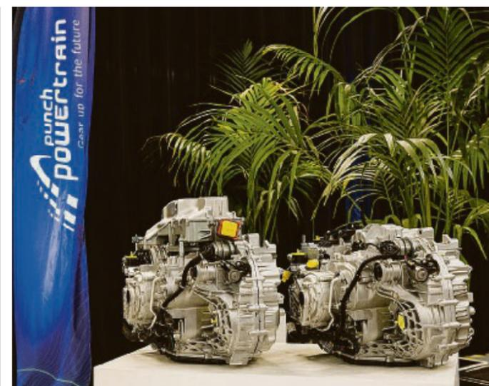
I nuovi sistemi di trasmissione eDct di Punch Powertrain
